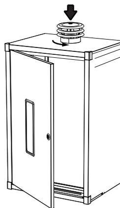
Un modelo de armario (800480300ARMPEG) incluye un deflector para la parte superior. Montar encajando y girando.
