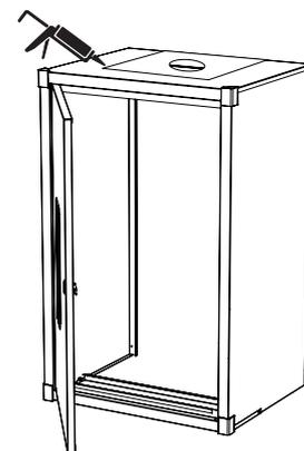
Se recomienda sellar las juntas para evitar filtraciones, sobretudo las de la parte superior del armario.
