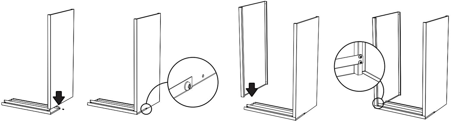
**2** Colocar el perno inferior, a continuación la puerta. Poner el perno superior que va en la puerta y montar el techo. Atornillar el techo completamente.
