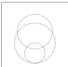
Ejemplo de la placa cubre techo con varios diámetros pre-cortados para utilizar el que mejor se adapte al conducto de evacuación.
